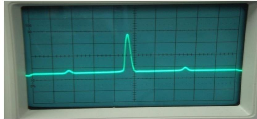
**定标：**即示波器X方向上的1格等于CCD器件上多少象元，或者示波器上1格等于CCD器件位置X方向上的多少距离。方法是调节示波器的“时基”档及“微调”，使信号波形一帧正好对应于示波器上的某个刻度数。本实验测量光强采用的是一维阵列CCD，共2592个像元，每个像元的长度为 $11\mu\text{m}$ 。如果波形一帧正好对应于示波器上的8.0大格，则每小格对应实际空间距离为 $2592\text{个像元} \div (8.0\text{大格} \times 5) \times 11\mu\text{m} = 0.7128\text{mm}$ 。
